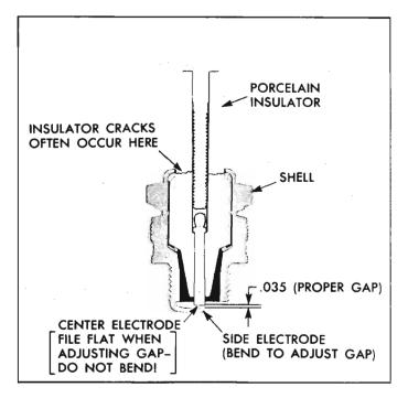
Fig. 8-63—Spark Plug Detail
