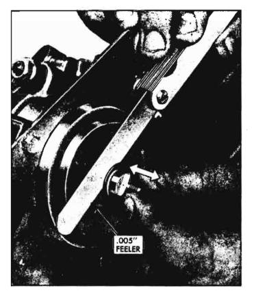
Fig. 8-131—Measuring Gear Shaft End Play
