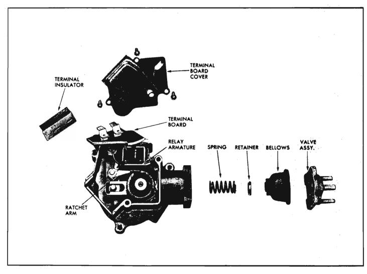
Fig. 8-142—Washer Pump Components
