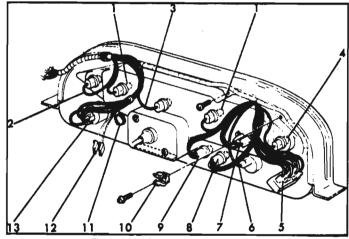
Fig. 8-114-Instrument Cluster Wiring
