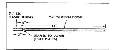
Fig. 8-62—Spark Plug Holding Tool
