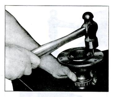
Fig. 33-Installing Pinion Shaft Pin
