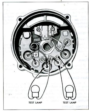
Fig. 18c-Checking Diodes
