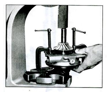
Fig. 53-Impeller Installation
