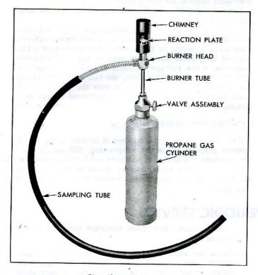
Fig. 13-Leak Detector
