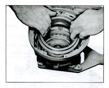
Fig. 7E-53-Installing Ring Gear
