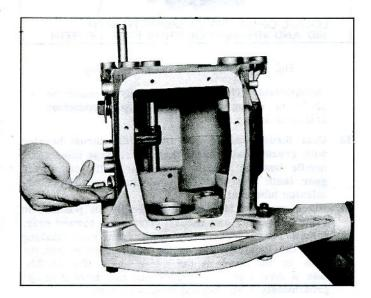
Fig. 7A-19-Installing Shift Forks Interlock
