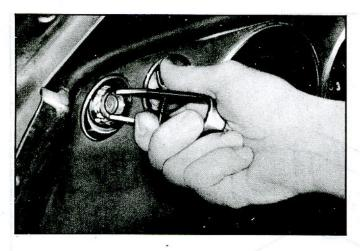
Fig. 12-Removing Bezel Nut
