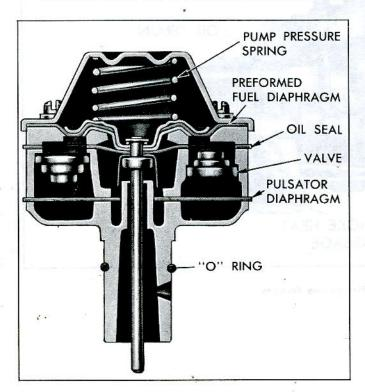
Fig. 57-Fuel Pump-Section View
