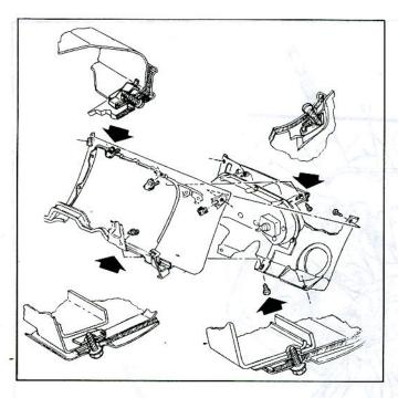
Fig. 24-Instrument Cluster Attachment
