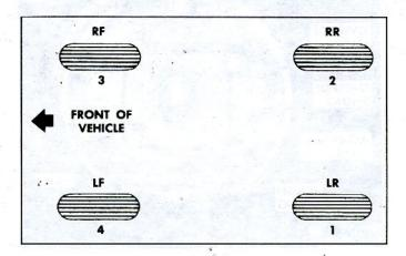
Fig. 4-Proper Bleeding Sequence
