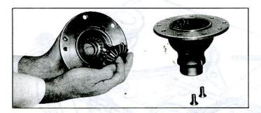
Fig. 58-Installing Side Gear
