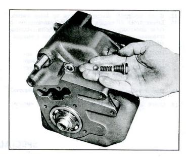
Fig. 7B-23-Installing 1-2 Shift Fork Detent Components
