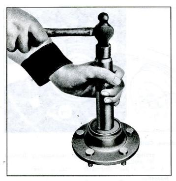
Fig. 3-8-Installing Bearing Cups
