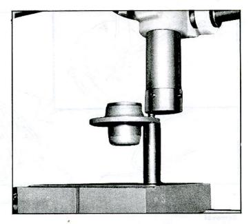
Fig. 3-9-Installing Hub Bolts
