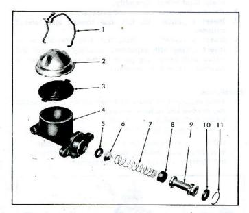
Fig. 22-Brake Main Cylinder
