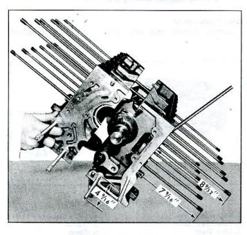
Fig. 110-Stud Installed Length
