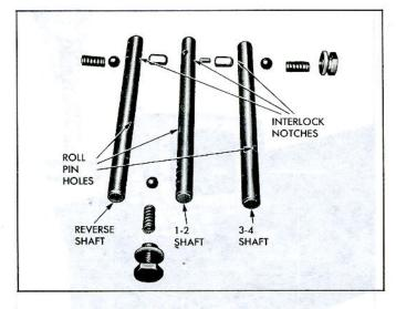
Fig. 7B-19-Shift Fork Shaft Identification
