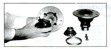
Fig. 57-Installing Clutch Pack
