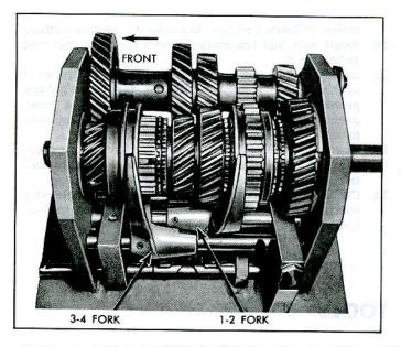
Fig. 7B-22-Shift Forks Installation
