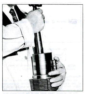
Fig. 107-Installing Piston in Cylinder
