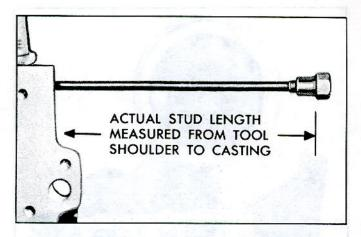
Fig. 109-Installing Studs
