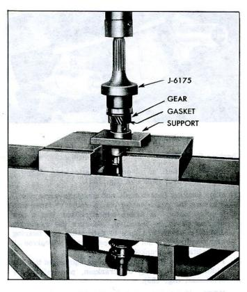
Fig. 121-Installing Crankshaft Gear
