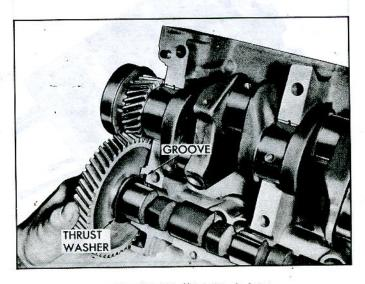
. Fig. 57-Installing Camshaft
