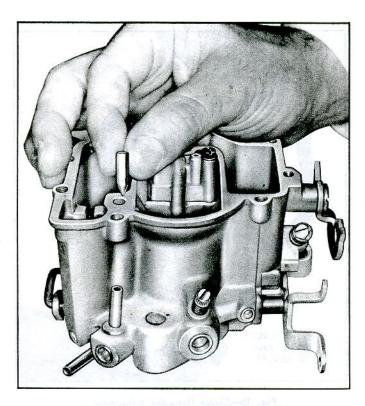
Fig. 9-Installing Pump Discharge Needle
