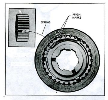
Fig. 7B-11-Synchronizer Spring and Hub Installation
