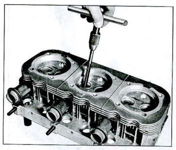
Fig. 87-Reaming Valve Guide
