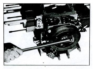
Fig. 63-Turning Crankshaft
