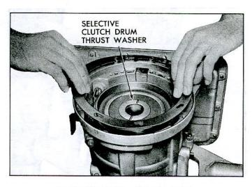
Fig. 7E-57-Installing Front Pump Gasket
