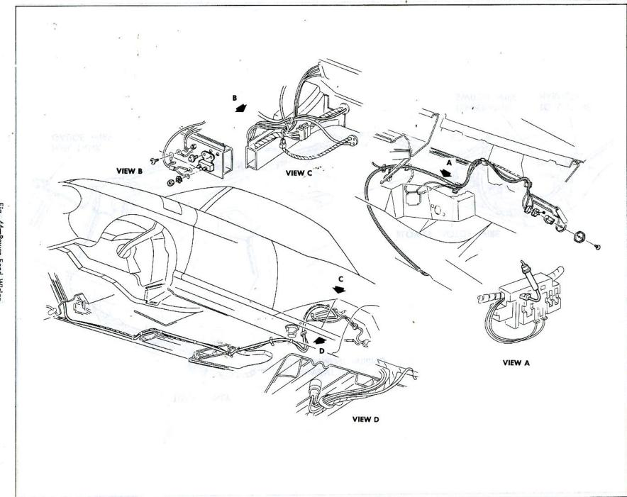
Fig. 44-Power Feed Wiring
