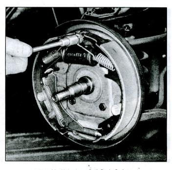
Fig. 18-Unhooking Pull Back Springs
