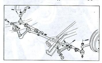
Fig. 2-Steering Linkage
