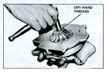
Fig. 40-Removing Impeller Nut
